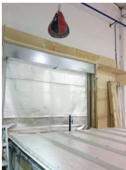
Ensayo de resistencia a impactos de cuerpo blando
