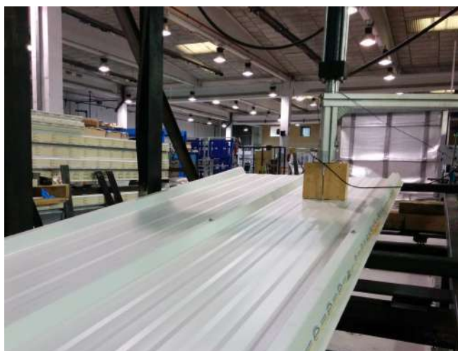
Montaje del ensayo de resistencia a caminabilidad
