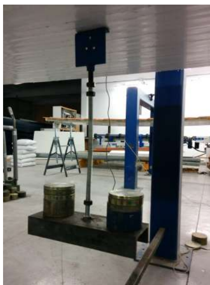
Montaje del ensayo de resistencia a cargas suspendidas
