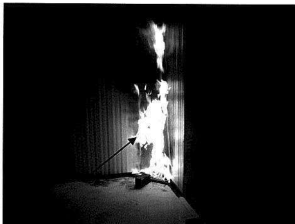
Figura 9: Execução do ensaio de reação ao fogo – Detalhe do chamejamento na região da junta.
