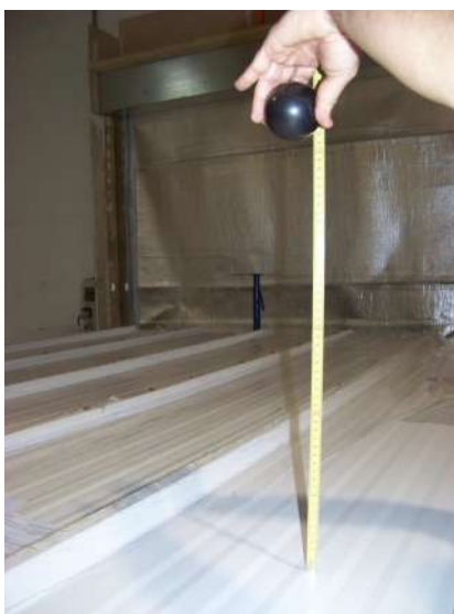
Ensayo de resistencia a impactos de cuerpo duro en tejados
