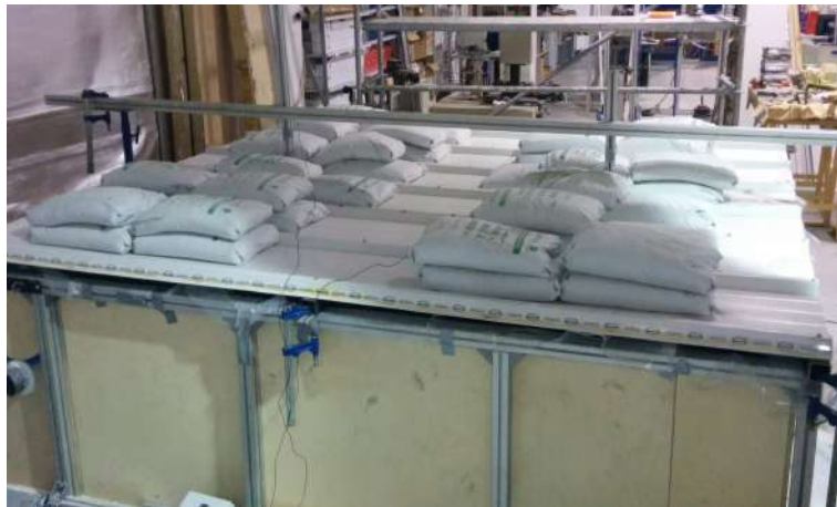
Montaje del ensayo de resistencia a carga distribuida positiva hasta rotura.
